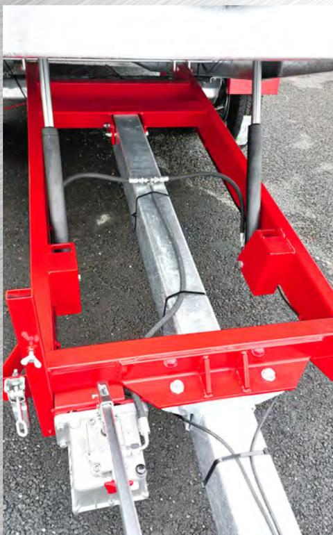
Timon articulé **basculant** hydraulique
