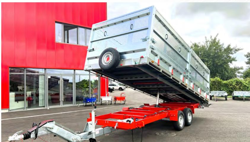
Timon articulé, rehausse, bennage électrique... (PB550x220)
