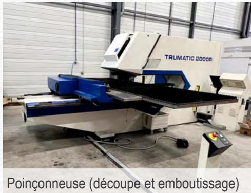
Poinçonneuse (découpe et emboutissage)
