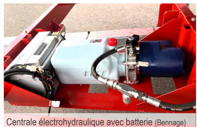
Centrale électrohydraulique avec batterie (Bennage)
