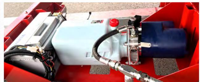
Centrale électrohydraulique avec batterie (Bennage)
